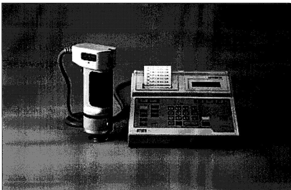
Figura 2.5 Colorímetro Minolta CR-200 (15)
