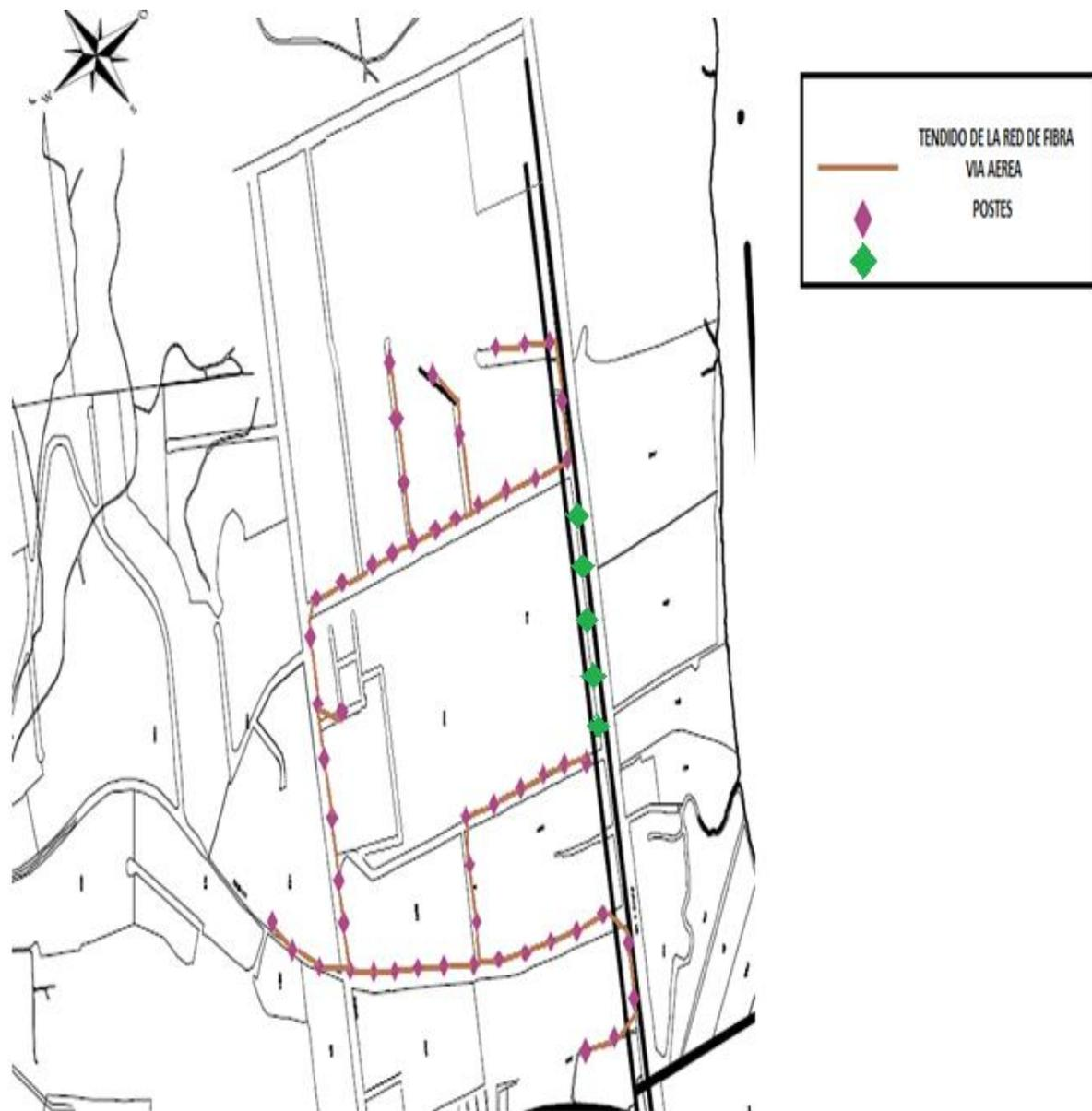
Figura 3.12: Tendido Aéreo de la Fibra Óptica
