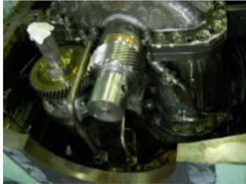
**Fig. 1.2: Transmisión de la señal de velocidad**
