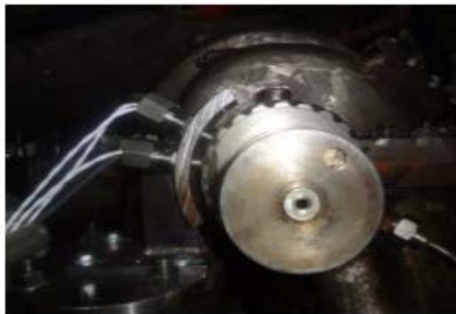
**Fig. 1.3: Sensor de velocidad**
