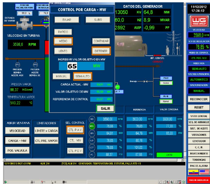
Fig. 2.11: Control por carga MW
