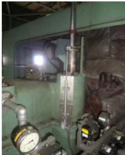
**Fig. 1.6: LVDT en campo para la GV**
