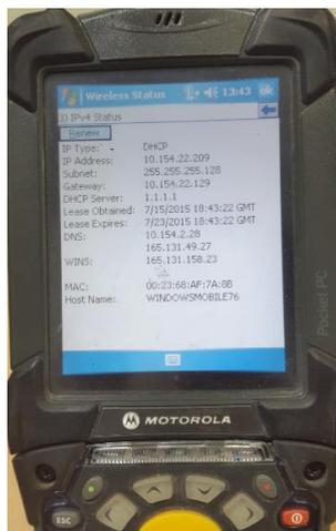
**Figura 2.8: Pocket obtiene dirección IP por DHCP**
