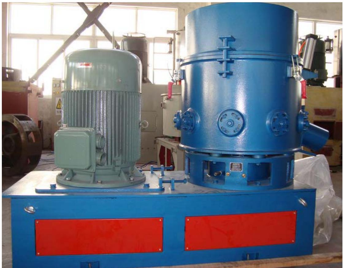
**Fig. 2.3: Máquina aglutinadora**
