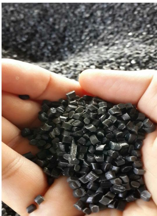
**Fig. 2.4: Pellets de polietileno reciclado**
