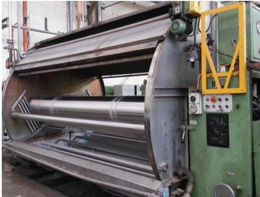
**Figura 0.1:** Máquina JIGGER X17
