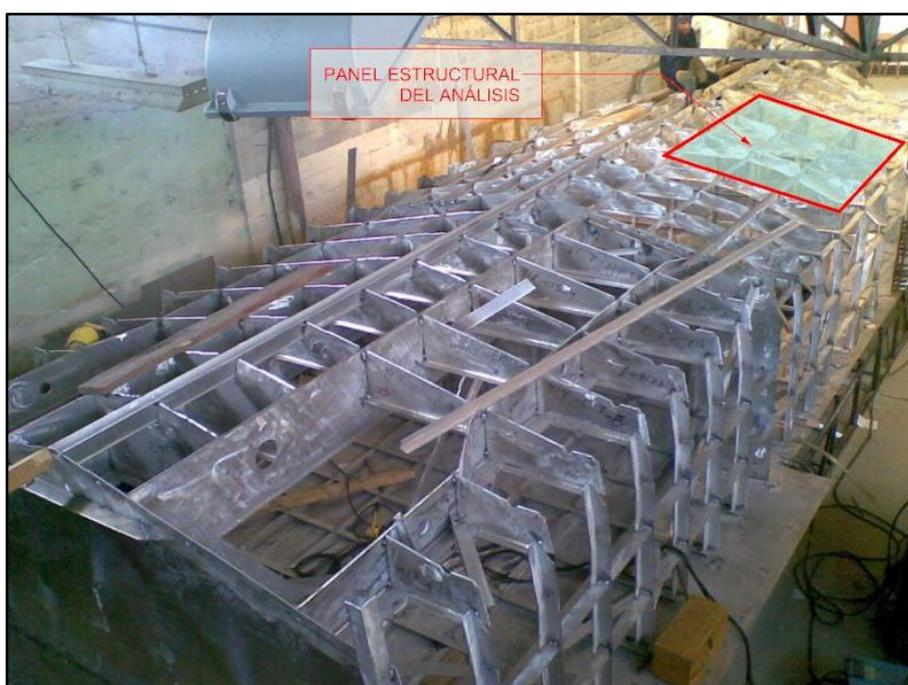
**Figura 1.6: Ubicación del panel en la estructura de la embarcación.**
