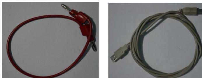
**Figura 1.5: Cables banana y USB.**
