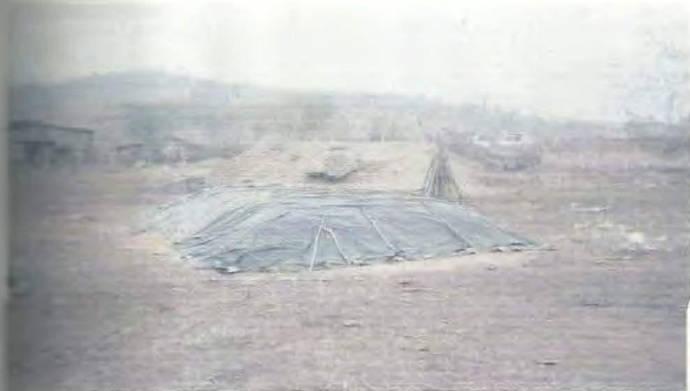
Figura 2B. Cubierta del material mezclado en la elaboración del compost a base de sólidos piscina de oxidación Primera etapa de mezcla Arenillas, El Oro. 2004.
