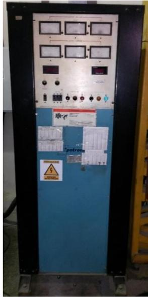
Figura 2.6. Autotransformador variable HIPOTRONIC.
