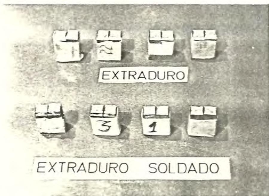
FIGURA N<sup>o</sup> 46.- Probetas de Ensayo de Impacto Grado Extraduro Soldado y sin Soldar.
