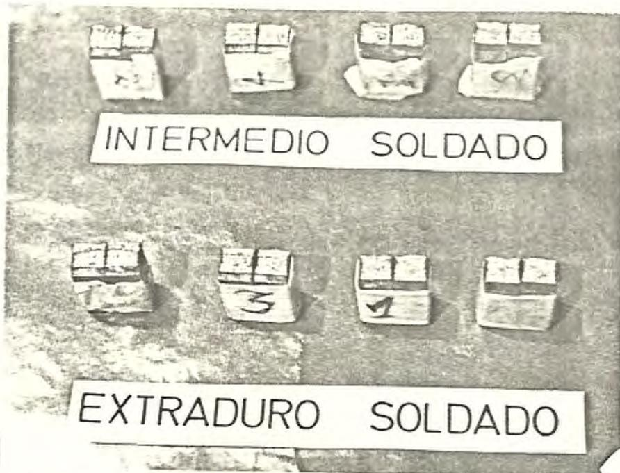
FIGURA N° 47.- Probetas de Ensayo de Impacto de Grados Intermedio y Extraduro con Puntos de Soldadura.
