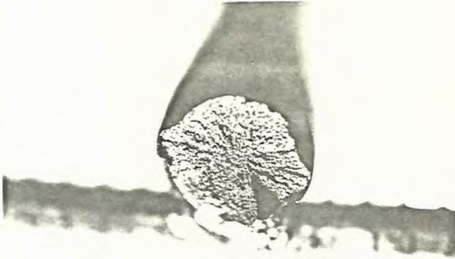
FIGURA N<sup>o</sup> 35.- Vista de la Superficie de Fractura de la Probeta N<sup>o</sup> 1 con la Barra de Estribo de Acero, Grado Intermedio después del Ensayo de Tracción.
