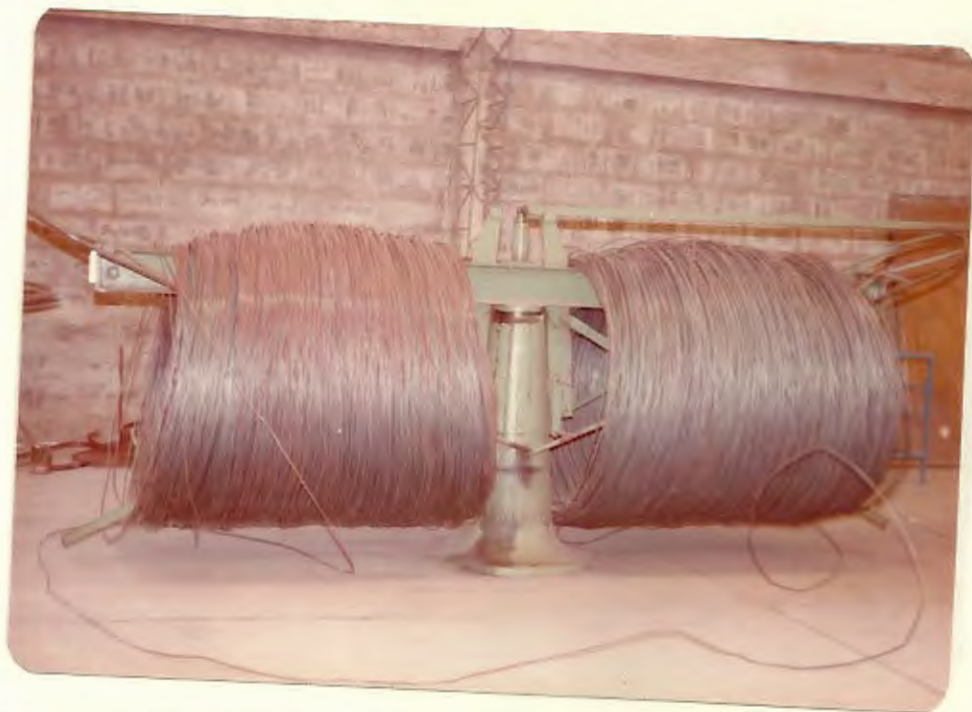
FIGURA Nº 18.- Portarrollos con los respectivos rollos en cada brazo, listos para pasar por la decalaminadora.
