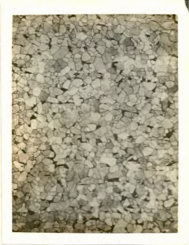
FIGURA N o 25.- Sección longitudinal del Alambrón Trefilado. Primer Paso de Reducción (x200).
