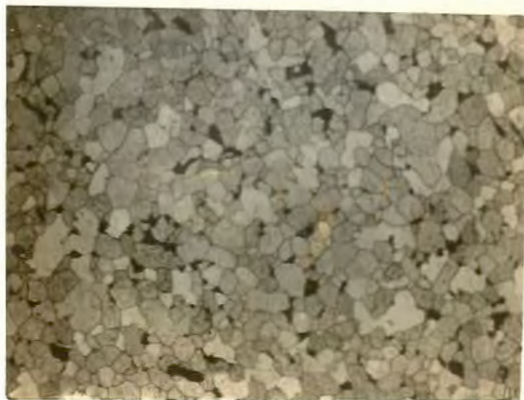
FIGURA N° 24.- Granos del alambre. Sección Transversal (x200).
