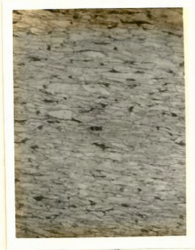
FIGURA N o 28.- Sección Longitudinal del Alambrón Trefilado. Cuarto Paso de Reducción (x200).
