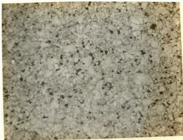
FIGURA N° 29.- Sección Transversal del Alambrón Trefilado. El Tercer Paso (x200).
