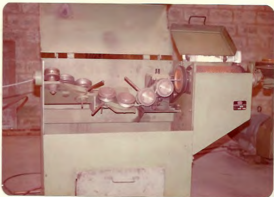
FIGURA N° 19.- Alambre pasado por los rodillos de la decalaminadora.
