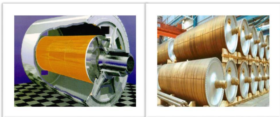
Figura 2.16: Secador de cilindro para hojas continuas.
