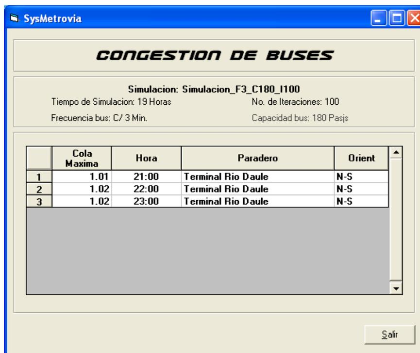
Esta pantalla consta del panel de parámetros del archivo de simulación, y muestra en sus columnas de detalle, el promedio de la cola máxima de Buses, la hora en que se presento la congestión y el paradero donde ocurrió especificando su orientación.
