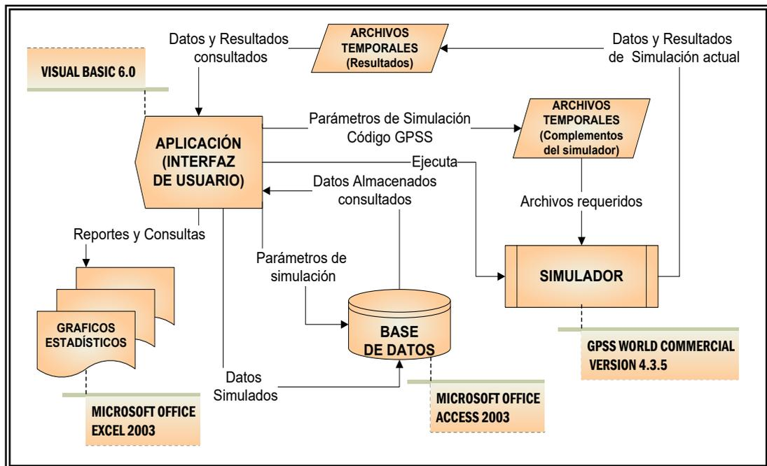
**Figura 2.2. Esquema del Simulador. Herramientas de Software**
