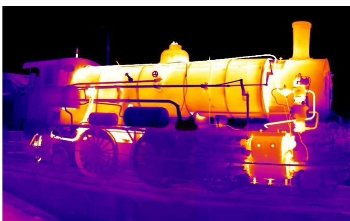
Figura 2.25 - Imagen en pseudo-color de un tren, las partes calientes toman un color amarillo con la subida de temperatura
