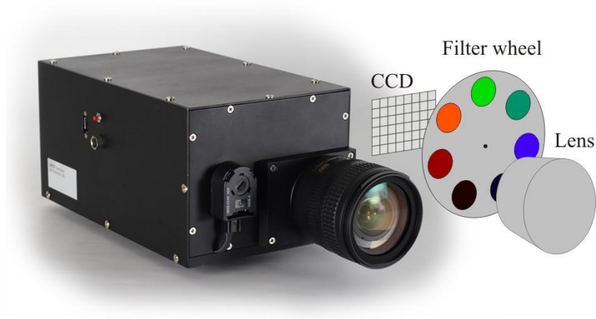
Figura 2.22 - Configuración de cámara para toma de imágenes multispectrales
