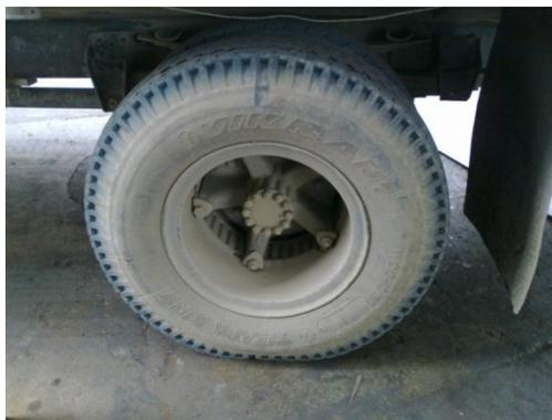
**Ilustración 5-1** Abertura de la llanta por exceso de carga en vehículo
