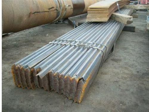
**Ilustración 2-8**Embalaje de ángulos metálicos
