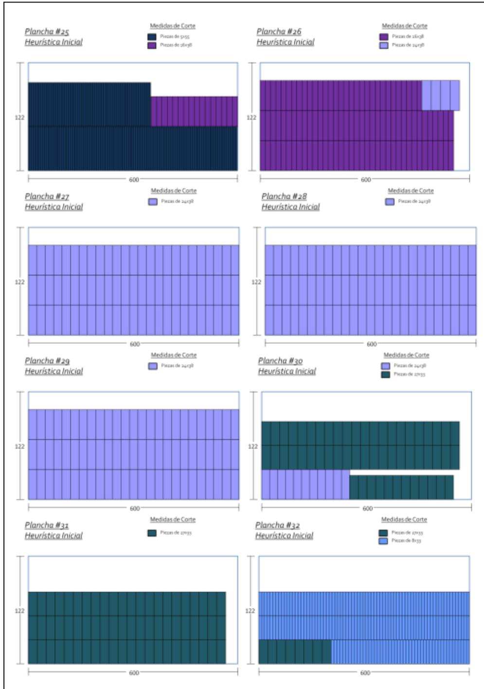
Figura 4-5. Diseños de corte: plancha 25 - plancha 32 "Heurística Inicial"
