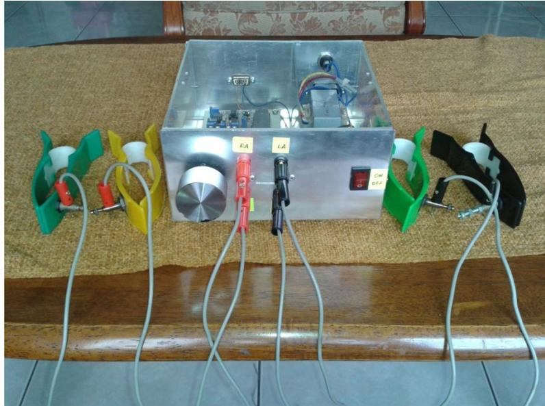
**Figura 4.6 Conexión de cables tipo banana entre EKG y electrodos**
