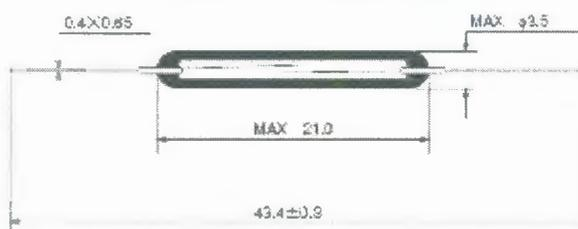
**Figura 21. Detalle de un Reed Switch.**
