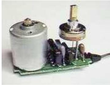
**Figura 2.30 - Servomotor internamente**
