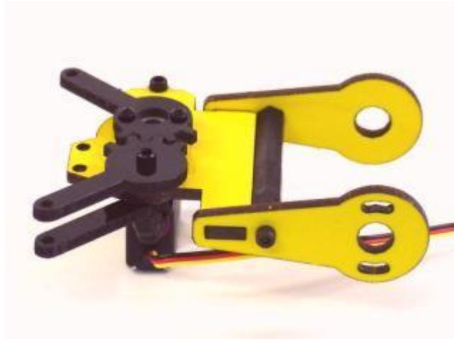
**Figura 2.19 - Paso 19 para armar el brazo robótico**
