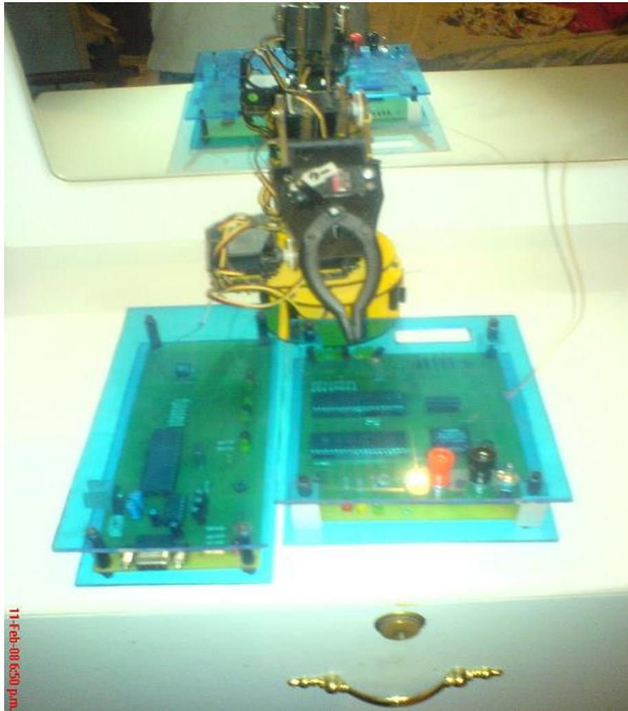
Figura 5.1 – Módulo transmisor, receptor y el brazo robot
