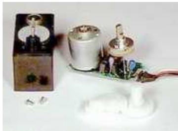
**Figura 2.31 - Otro modelo interno de un servomotor**
