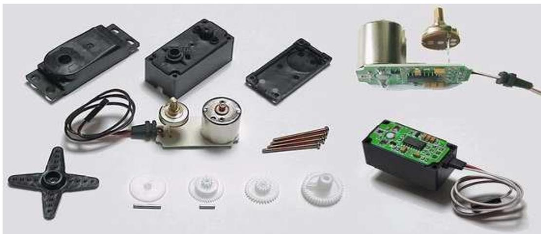
**Figura 2.29 - Diferentes componentes de un servo**
