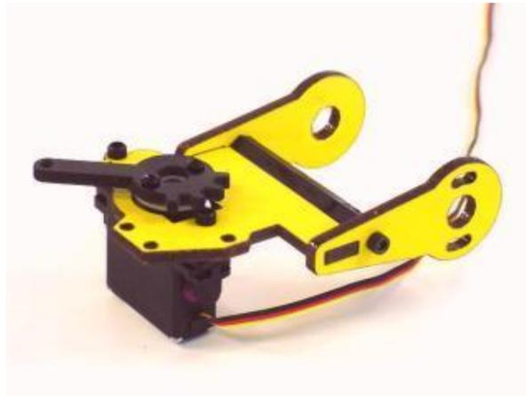
**Figura 2.18 - Paso 18 para armar el brazo robótico**
