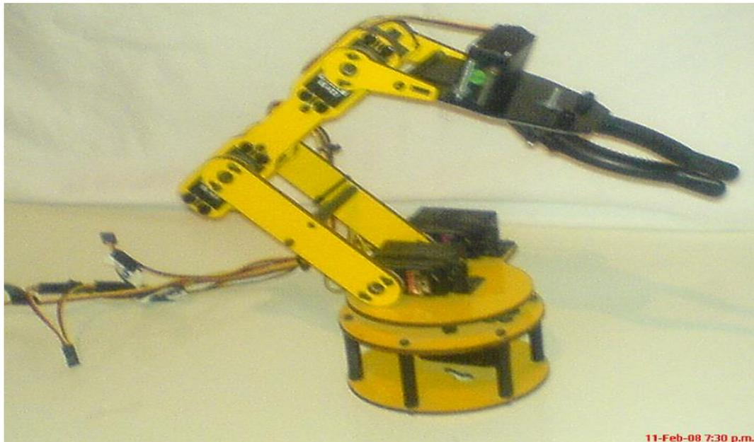
**Figura 1.4 – Brazo Robot con la nueva pinza**
