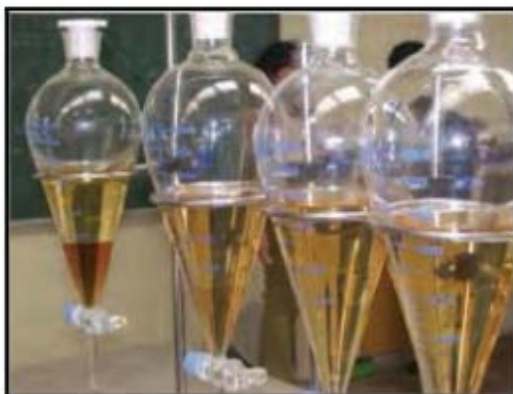
FIG.4.2 PROCESA DE DECANTACION DE GLICERINA LUEGO DEL PROCESO DE TRANSESTERIFICACION
