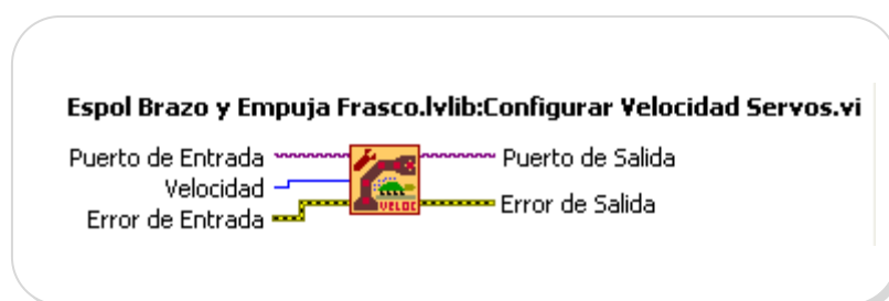
Figura 3- 13 Configurar velocidad de servos
