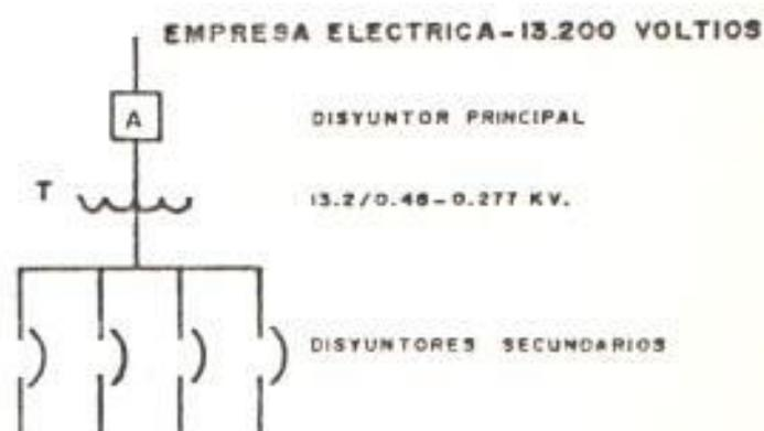
Fig. 2.10. Esquema de protección con relevador de sobrecorriente en el primario.
