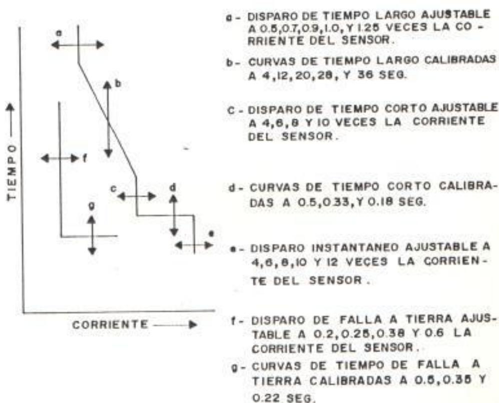
**FIG. 4.9.- SINTESIS DEL RANGO DE AJUSTES DE UN DISYUNTOR DE ESTADO SOLIDO.**
