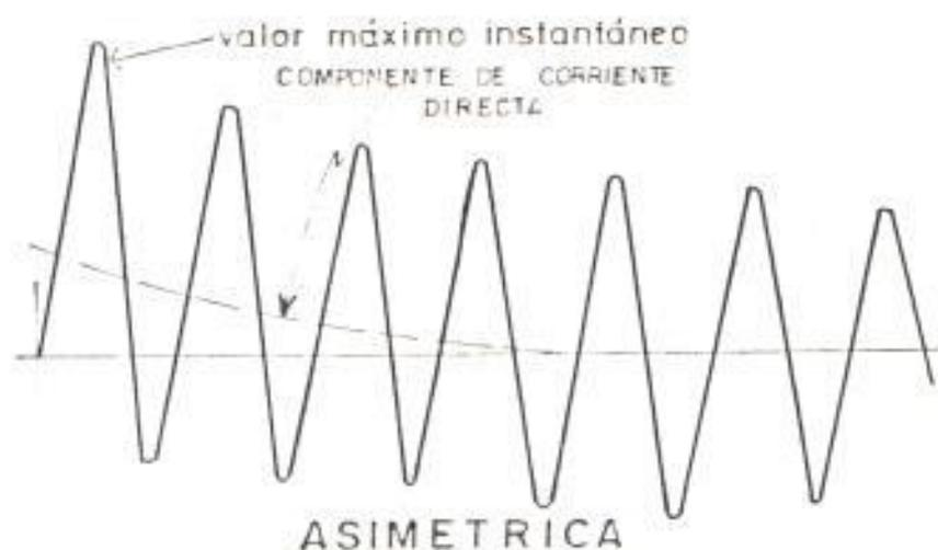
Fig. 1.6. Forma de onda de una corriente asimétrica
