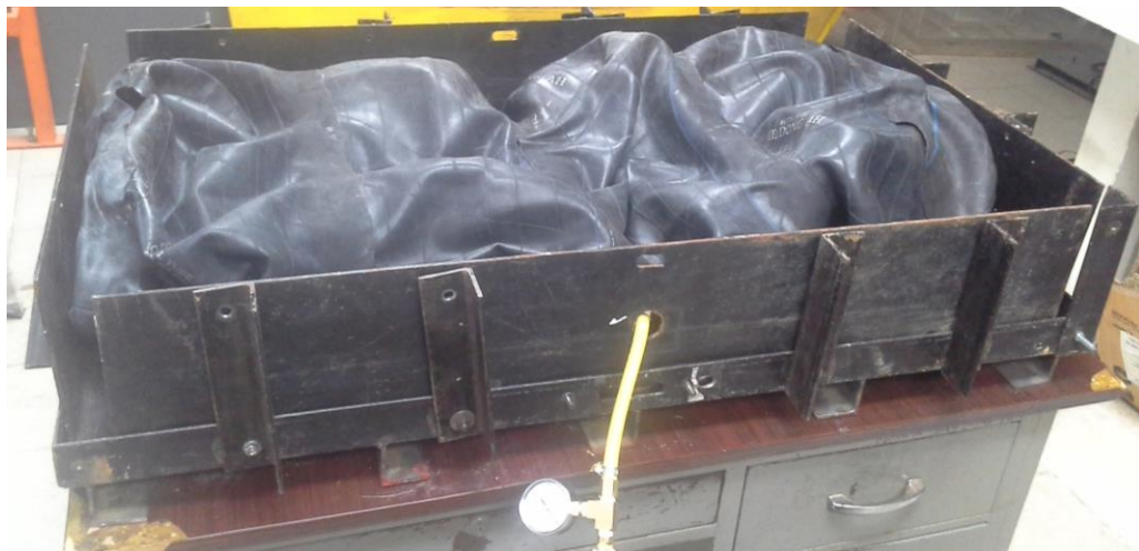
FIGURA 20. Ubicación de la bolsa de aire a presión dentro de la base estructural de acero, con el sistema de alimentación de aire.
