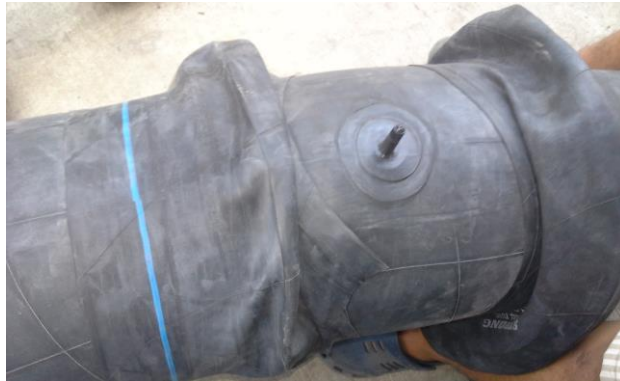
FIGURA 19. Tubo con la válvula en su nueva posición, comenzando a forrarla con caucho.
