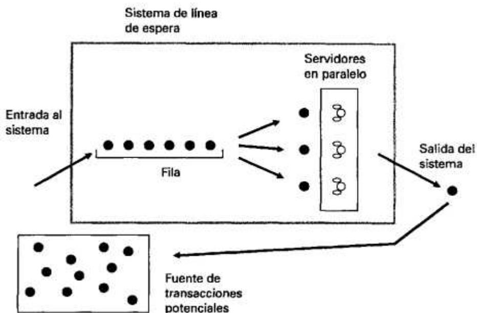
Figura5.41: Estructura de un sistema de línea de espera
