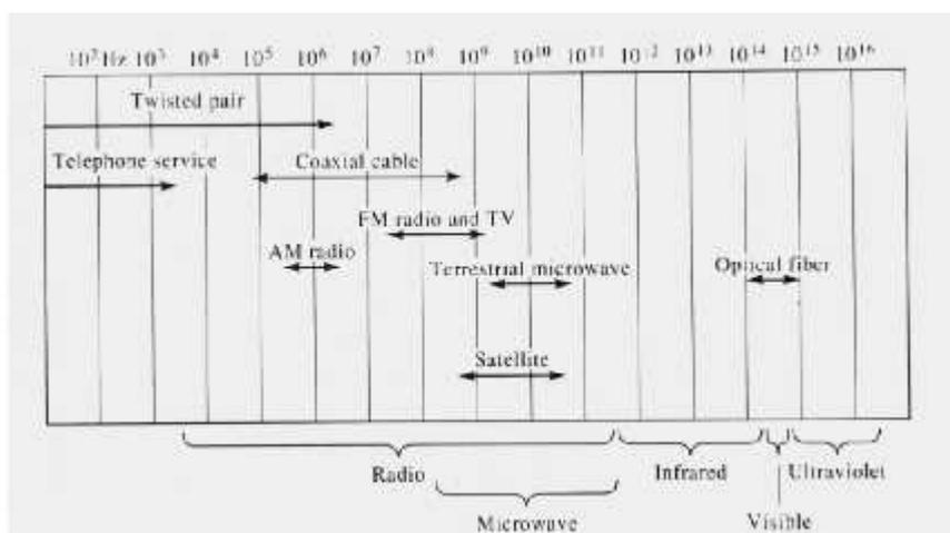
Figura 2.4: Espectro de frecuencias para diferentes medios de transmisión [18]
