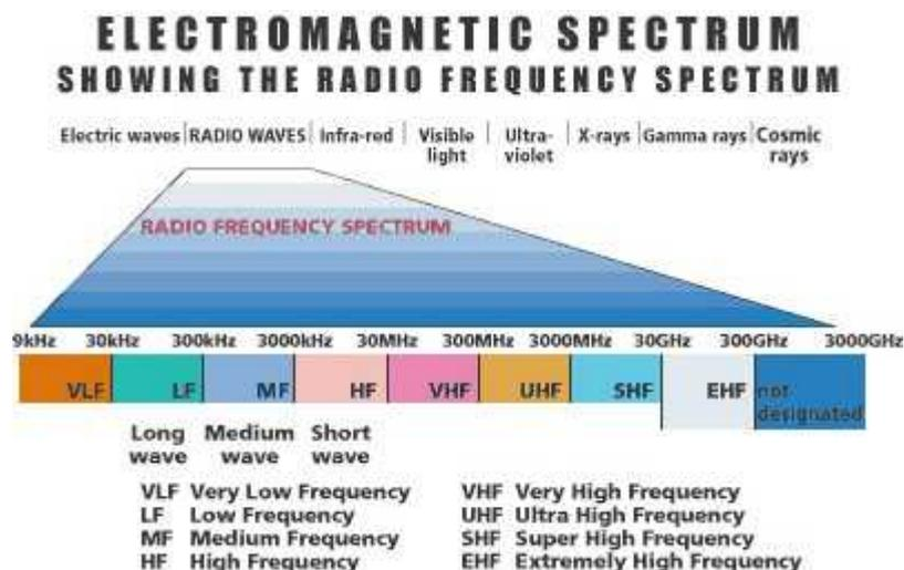
Figura2.5: Espectro electromagnético mostrando el espectro radioeléctrico [20]
