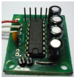
**FIGURA 4.10** Convertidor de serial RS232 a Serial TTL
