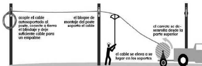
Figura 2.7 Método con desplazamiento del carrete [31].
