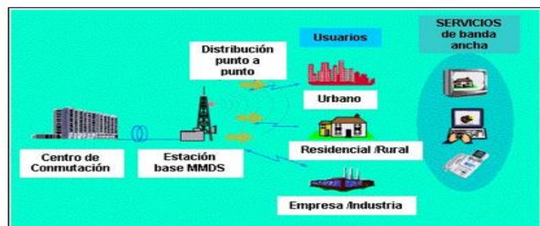
Figura 1.6 Esquema de Televisión Codificada Terrestre UHF y MMDS
