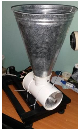
FIGURA 3.2: PLATAFORMA DE PESAJE Y DOSIFICACION
