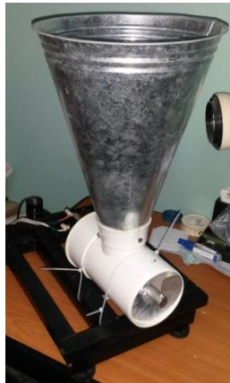
FIGURA 3.2: PLATAFORMA DE PESAJE Y DOSIFICACION
