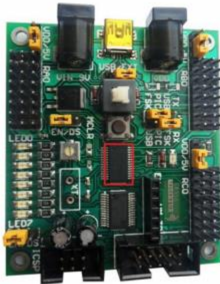
FIGURA 3.2 Módulo PIC 16F886 (Obtenido de Manual M.E.I&T)
