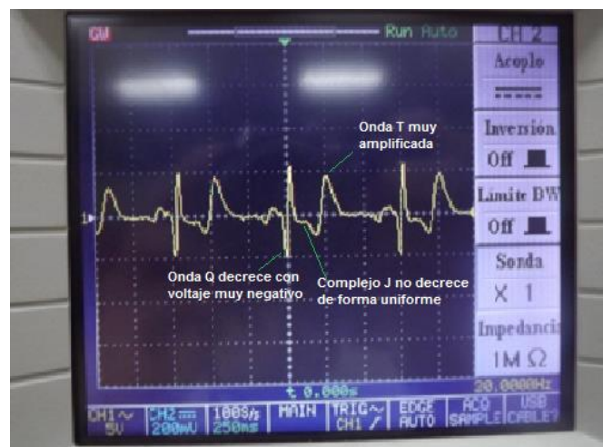
FIGURA 4.3 Señal con problemas de capacitancia
