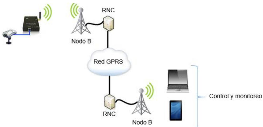
Figura 2.2: Esquema del funcionamiento de servicios M2M.
