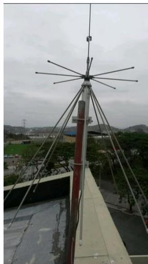
Figura 3.2 Antena Sirio SD 2000 U
