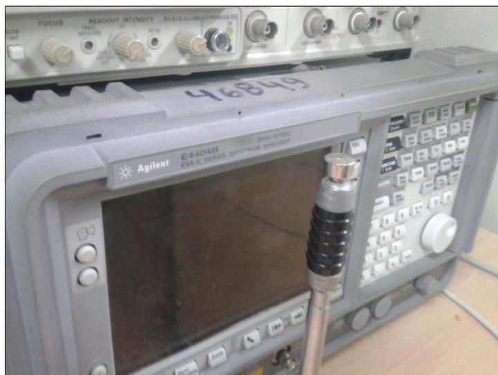
Figura 3.3 Analizador de Espectro Agilent E4404B
