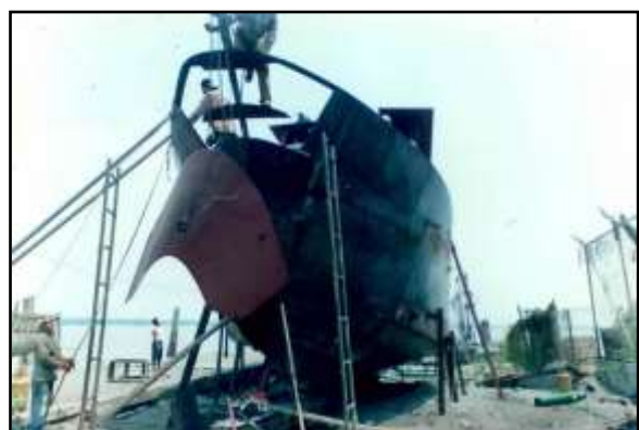
Figura 14. Planchaje de proa. Fuente: propia
