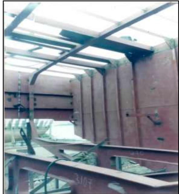
**Figura 14.** Colocación de planchas de costado.
