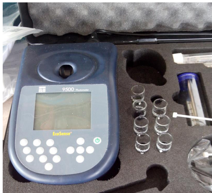
Anexo B: Kit YSI utilizado para los análisis de calidad de agua durante la prueba.
