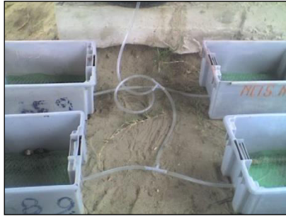
Figura 11.- Distribución del agua bombeada en el sistema
