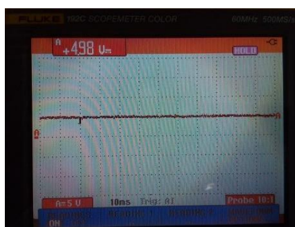
Figura 3.1 Gráfica de voltaje en la fuente de +5V
