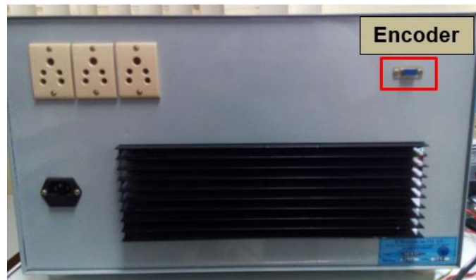
Figura 3.30 Conector de encoder en la parte posterior del equipo
