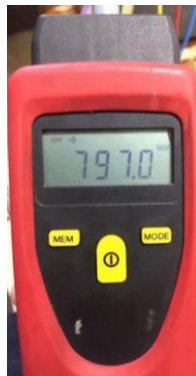
Figura 4.27 Medición de 797.0 RPM utilizando un tacómetro
