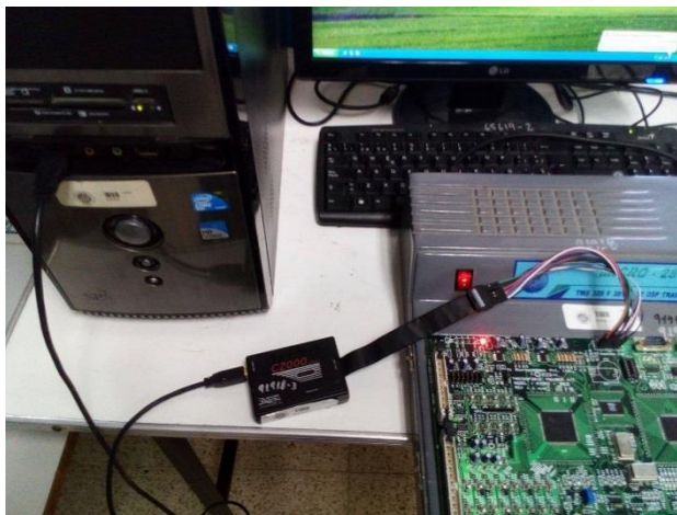
Figura 3.70 Conexión entre la PC y el controlador MICRO 2812
