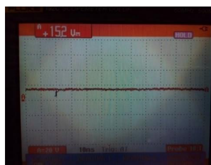
Figura 3.2 Gráfica de voltaje en la fuente de +15V
