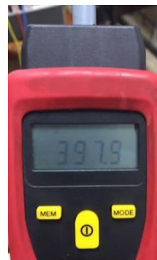
Figura 4.25 Medición de 397.9 RPM utilizando un tacómetro
