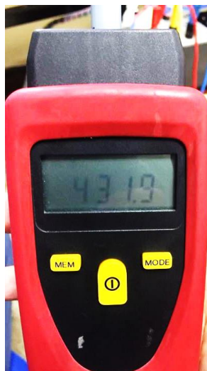
Figura 4.18 Velocidad de giro del motor obtenida con un tacómetro
