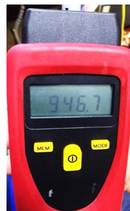
Figura 4. 21 Velocidad de 946.7 RPM obtenida con tacómetro
