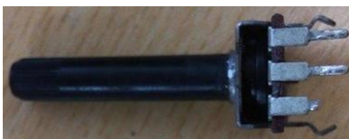
Figura 3.7 Pin roto en el Potenciómetro Iset
