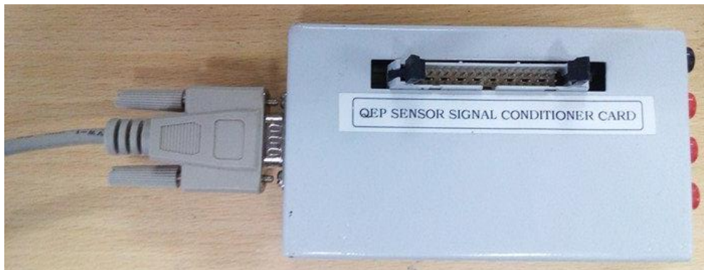
Figura 31 Conexión entre el encoder y el adaptador PEC-01-ESC
