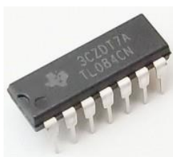
Figura 4.4 Amplificador Operacional TL084 nuevo
