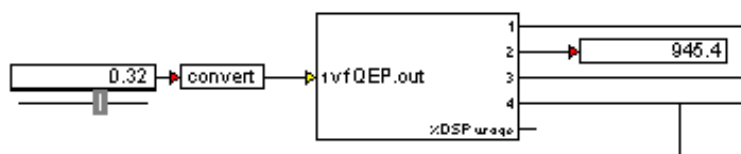
Figura 4.19 Frecuencia de comando de 0.32 y Velocidad del motor en 945.4 RPM visualizada en VisSim
