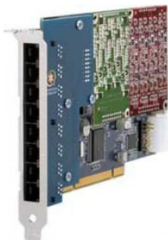
Figura 1.1: Tarjeta PCI Asterisk TDM800P con Módulos FXO y FXS (4 puertos cada uno).
