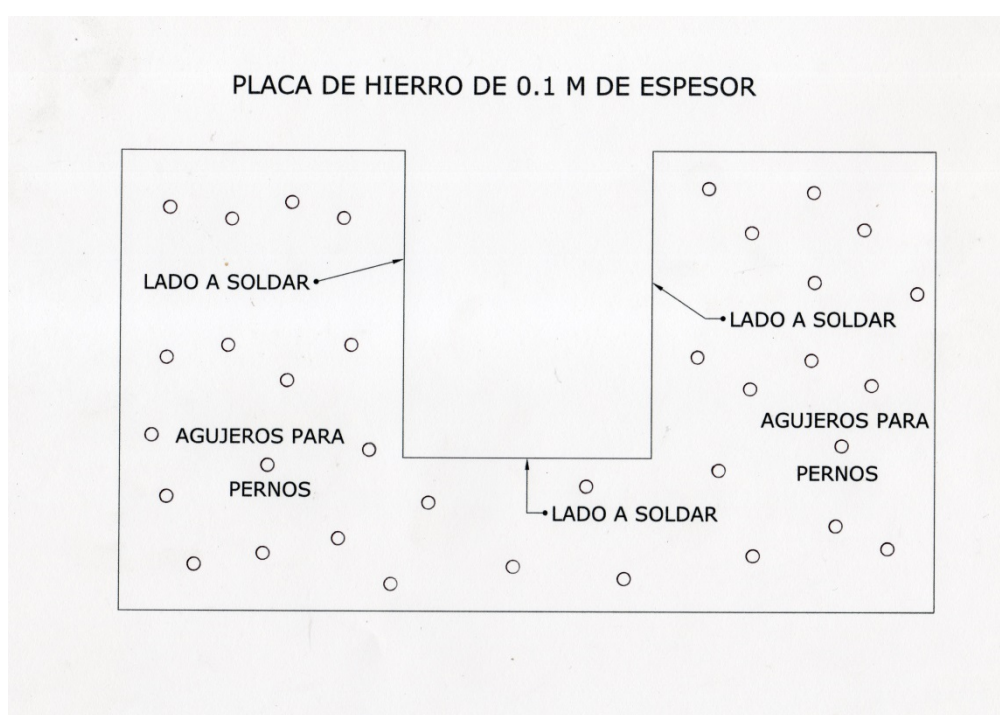
Fig. 2.1: Placa para instalación de mesa de RX
