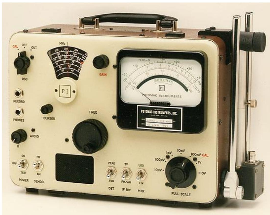
**Fig. 2.3 Medidor de Intensidad de Campo FIM-71 (Cortesía de Potomac Instruments)**
