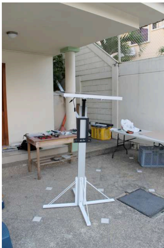
Figura 2.2 Estructura portante de panel fotovoltaico
