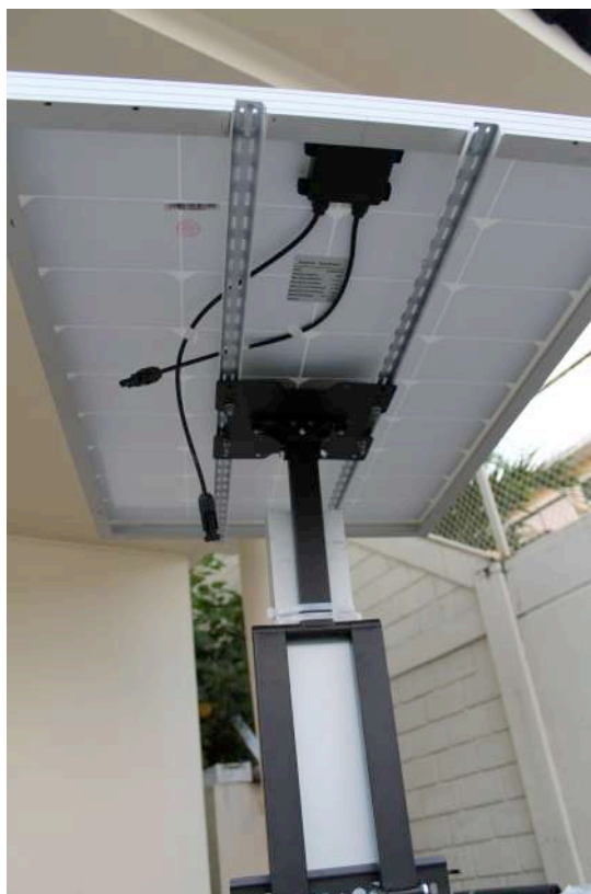
Figura 2.3 Base soporte inferior con pivot para panel fotovoltaico
