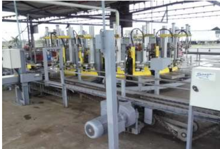
Figura 2.3: Envasadora Automática de GLP
