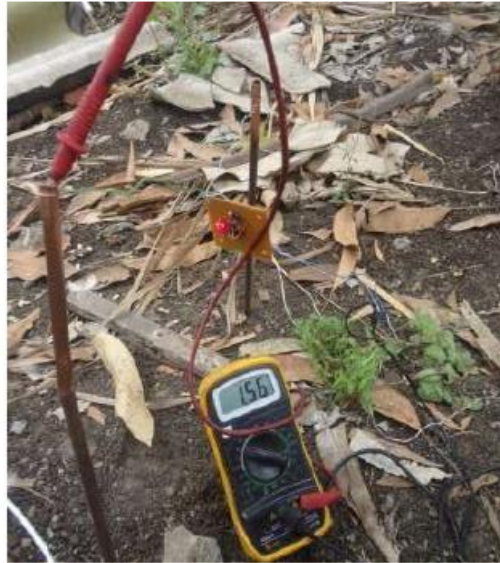
Figura 2.12 pruebas de campo del sensor de humedad
