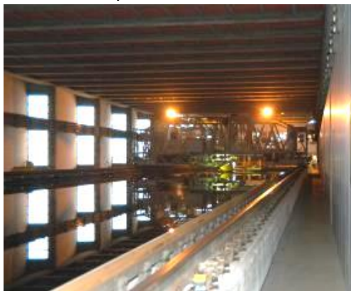
Figura 33. Tanque de arrastre #2 del CEIMM.
