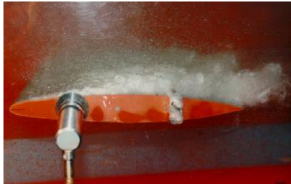
Figura 5. Cavitación de nube en un hidrofolio.
