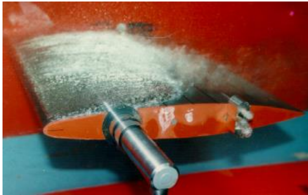
Figura 4. Cavitación de hoja y de burbuja en un hidrofolio.
