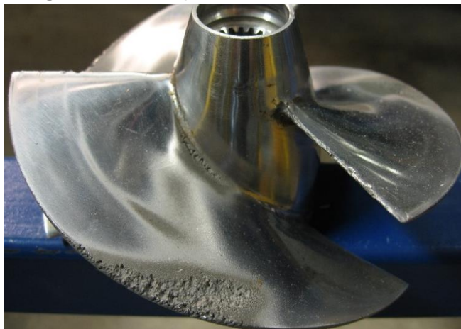
Figura 2. Daños por cavitación en una hélice.
