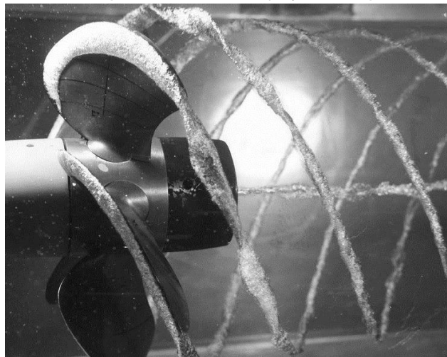
Figura 1. Cavitación tipo vórtice en el eje y en las puntas de las palas.
