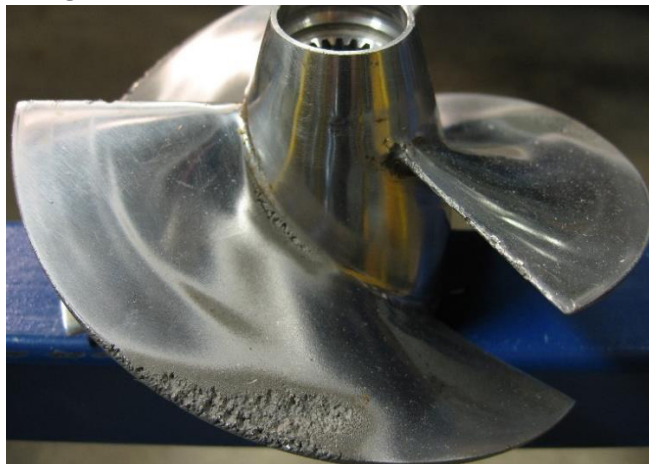
Figura 2. Daños por cavitación en una hélice.
