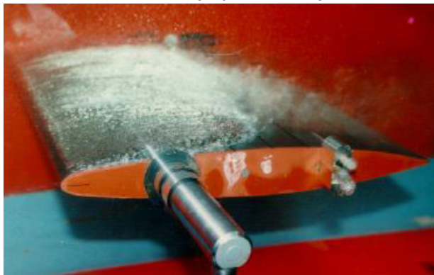
Figura 4. Cavitación de hoja y de burbuja en un hidrofollío.
