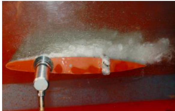
Figura 5. Cavitación de nube en un hidrofolio.
