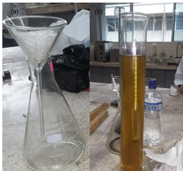
Figura 7 (a) Kit de filtración para aceite crudo; (b) Determinación de la densidad de aceite Fuente: Aveiga-Peñañiel, 2017 Elaboración: Propia
