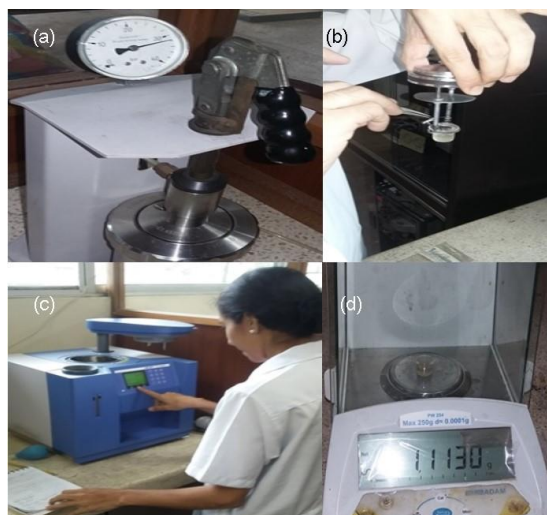
Figura 11 : (a) Pesado de muestra de aceite en el crisol; (b) Embebido de hilo en muestra de aceite; (c) Presurizado del contenedor de descomposición con oxígeno; (d) Ingreso de datos en el equipo
