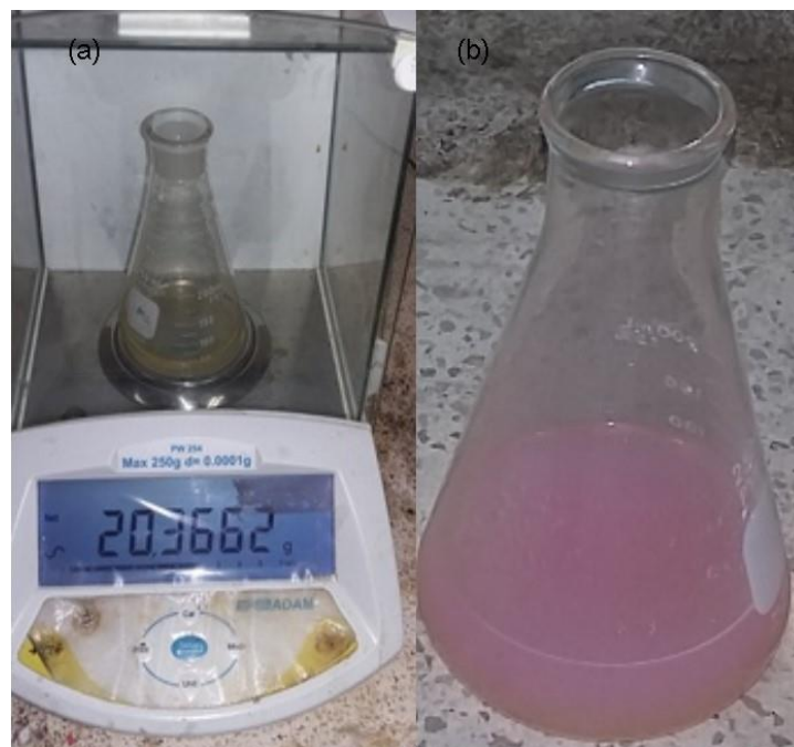
Figura 8: (a) Pesado de muestra de aceite; (b) Punto de equivalencia para titulación
