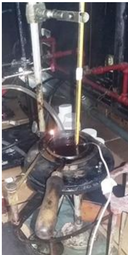
Figura 9 Sistema para obtención de punto de inflamación
