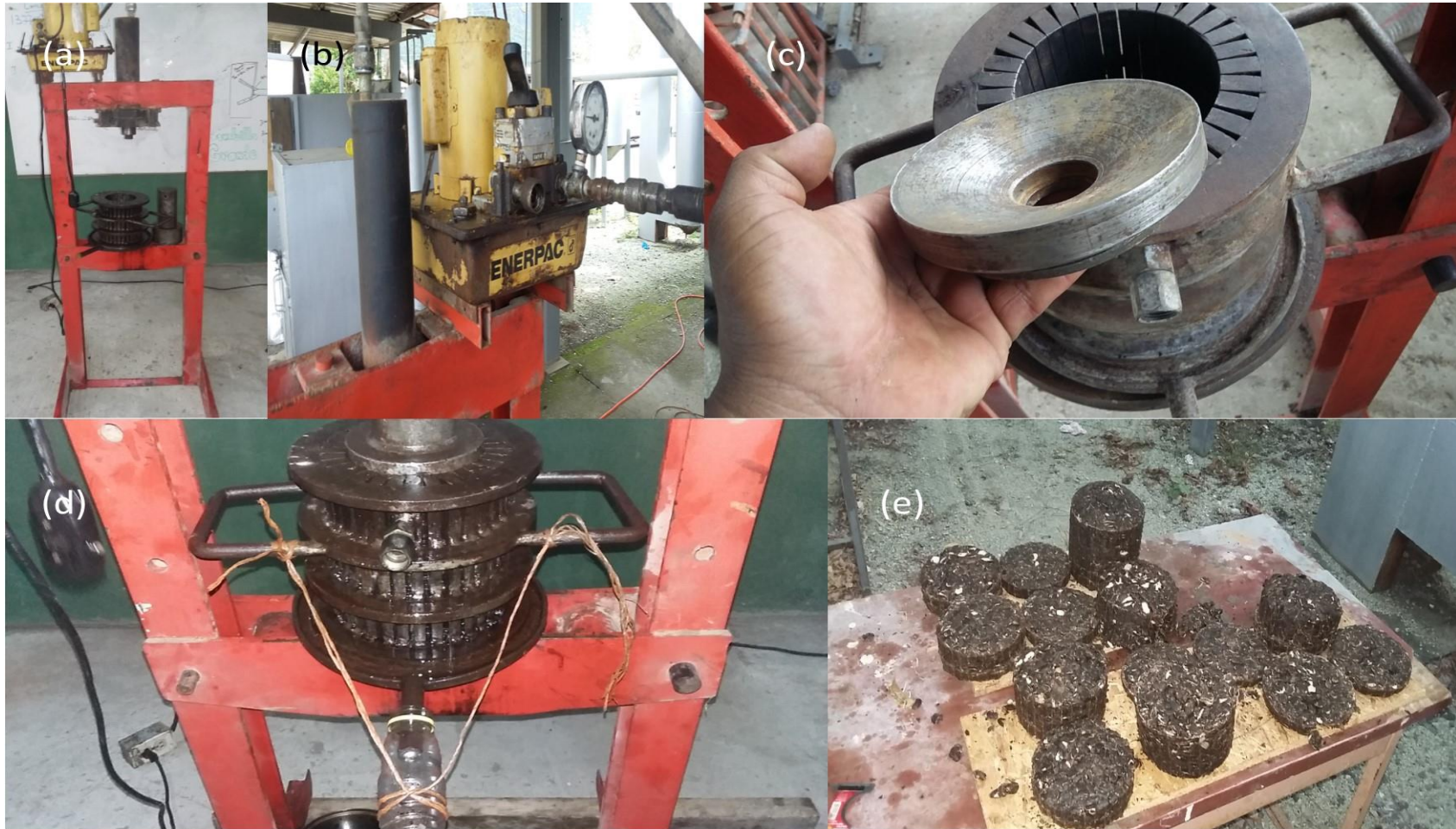
Fotografías: (a) Prensa hidráulica, (b) bomba hidráulica, (c) disco de soporte y cilindro, (d) extracción de aceite, (e) tortas de pruebas experimentales realizadas.
