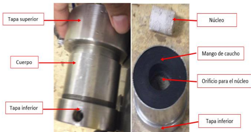
Figura 2.29 Partes del portanúcleo actual (permeámetro Ruska)
