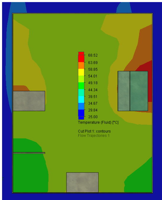
Figura 3.1. Distribución de temperatura en el plano medio frontal del case sin ventilación
