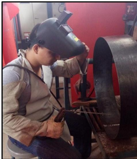
**Figura 3.27: Soldadura a tope del cilindro rolado de la base de soporte**
