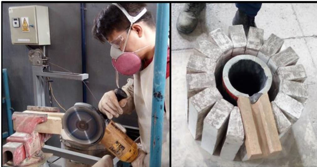
**Figura 3.7: Mecanizado del ladrillo refractario para realizar el canal de vaciado**
