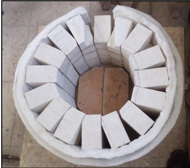
**Figura 3.5: Matriz de ladrillos que conforman el cuerpo del horno**
