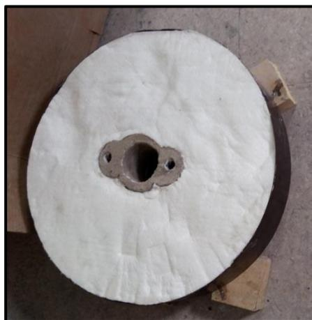
**Figura 3.38: Instalación de la manta refractaria en la tapa del horno**
