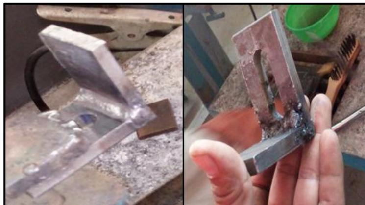
**Figura 3.22: Cordón de soldadura realizado en las orejas de soporte**
