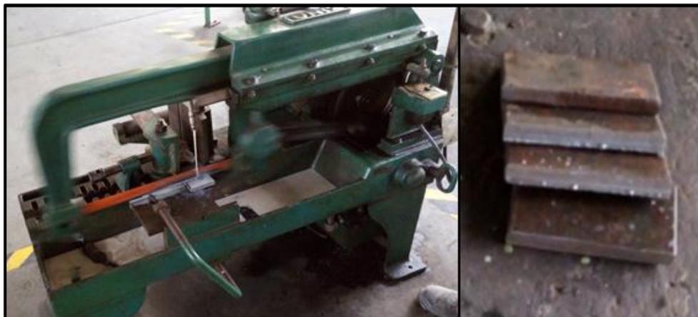
**Figura 3.19: Proceso de corte de las platinas para las orejas de soporte**
