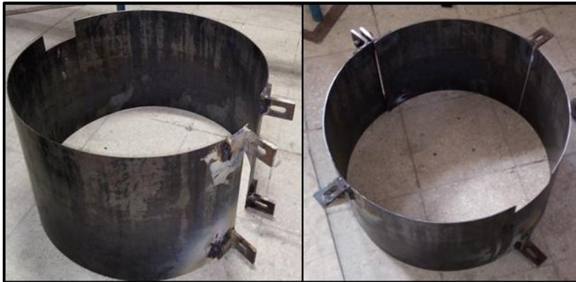
**Figura 3.23: Orejas de soporte soldadas a la carcasa del cuerpo del horno**
