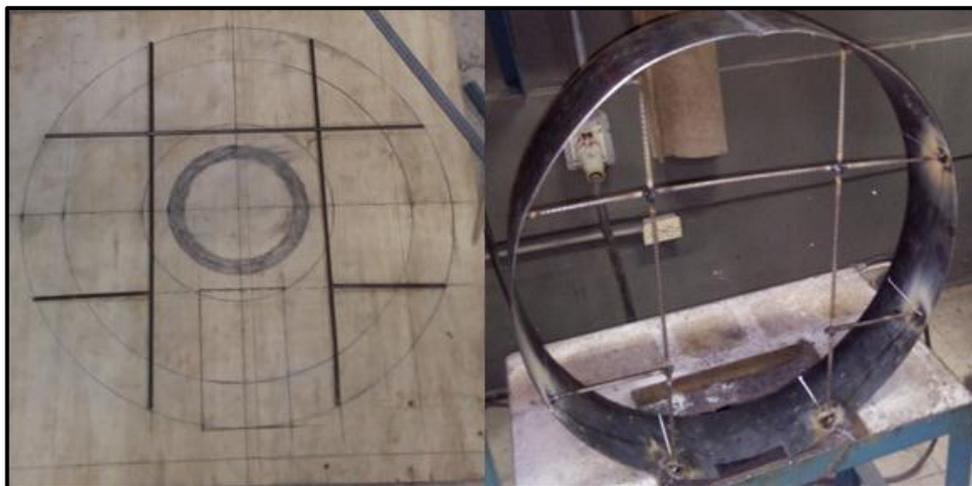
**Figura 3.35: Mallado de varillas corrugadas en la tapa del horno**
