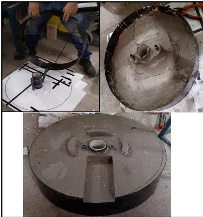
**Figura 3.37: Concreto refractario de la tapa del horno.**
