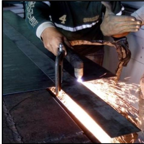
**Figura 3.13: Corte con plasma para la carcasa de la tapa y base del horno**
