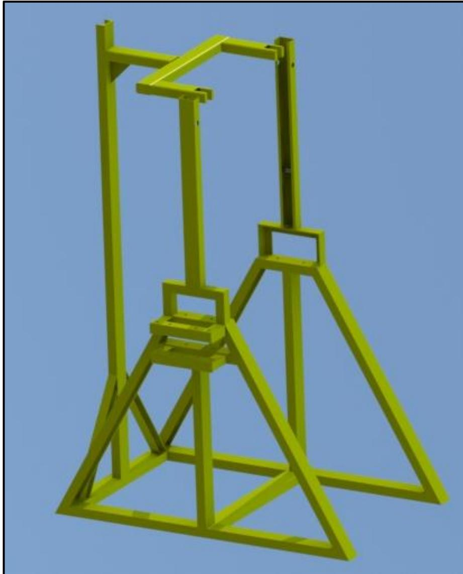
**Figura 2.27: Esquema de la estructura de soporte del horno basculante**
