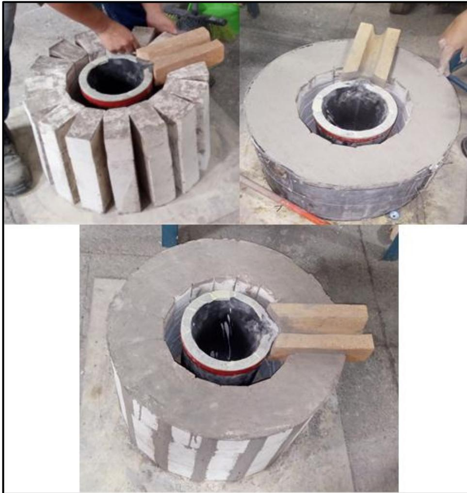
**Figura 3.9: Cuerpo cilíndrico del horno**
