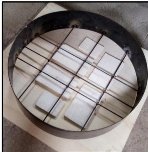
**Figura 3.29: Mallado soldado en la carcasa**
