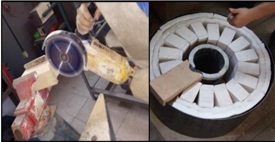
**Figura 3.6: Mecanizado del ladrillo refractario para realizar el pico del crisol**
