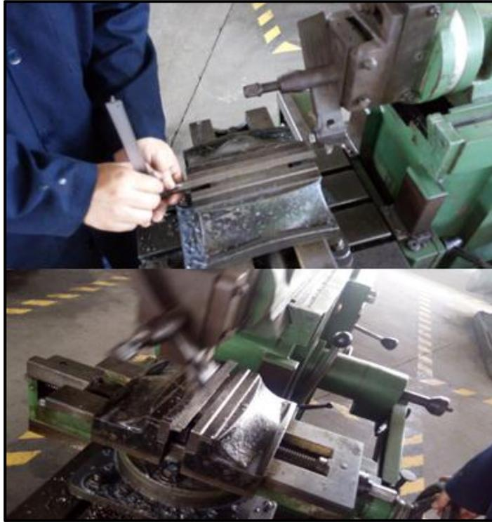
**Figura 3.42: Construcción de las chavetas**
