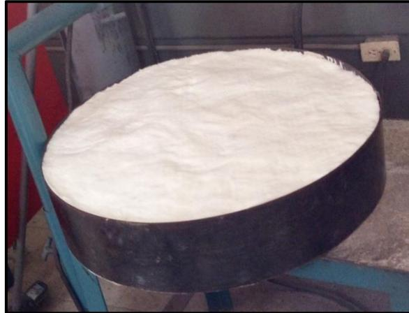
**Figura 3.31: Instalación de manta refractaria dentro de la base de soporte**
