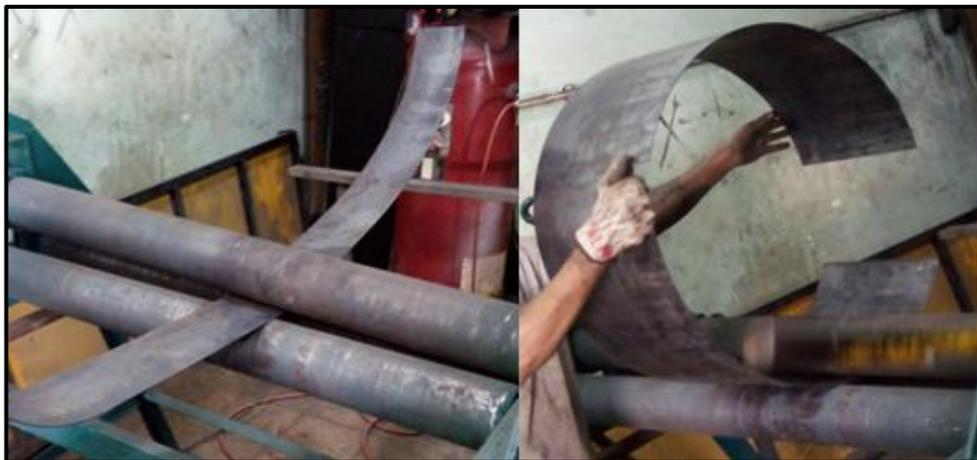
**Figura 3.16: Proceso de rolado para dar la forma cilíndrica**
