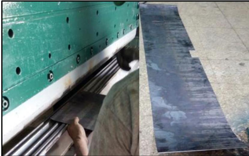
**Figura 3.15: Proceso de preformado en prensa mecánica**
