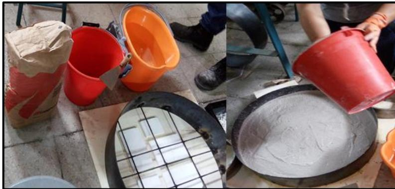
**Figura 3.30: Preparación de la mezcla de concreto y vertido en la carcasa**
