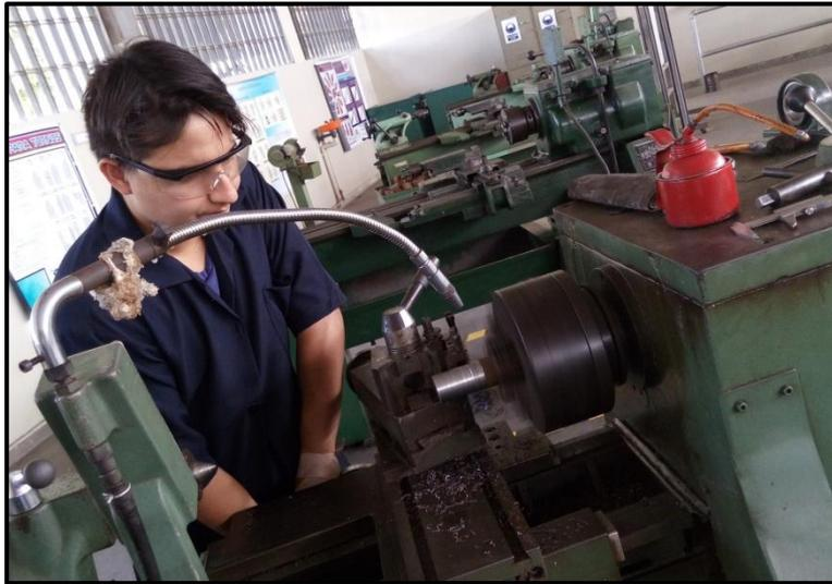
**Figura 3.40: Proceso de maquinado del eje del sistema basculante**
