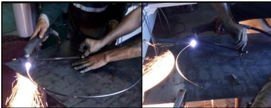
**Figura 3.14: Corte con plasma para discos de la tapa y base del horno**
