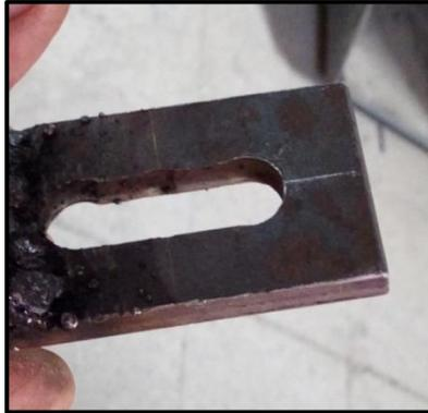
**Figura 3.21: Canal realizado en las platinas transversales de las orejas de soporte**
