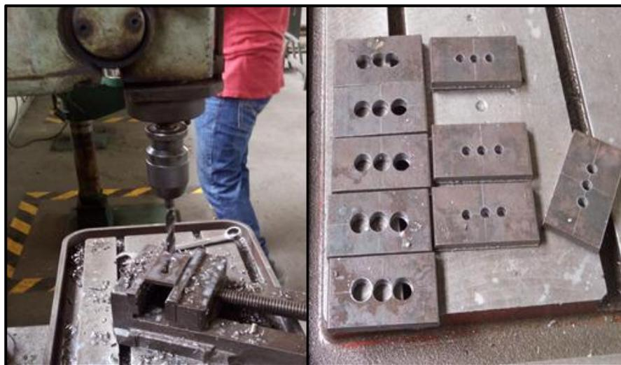
**Figura 3.20: Proceso de taladrado en las platinas que conforman las orejas**
