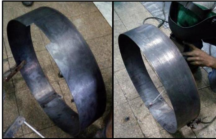
**Figura 3.17: Carcasa de la tapa y base del horno**
