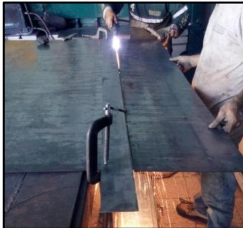
**Figura 3.12: Corte con plasma para la carcasa del cuerpo del horno**
