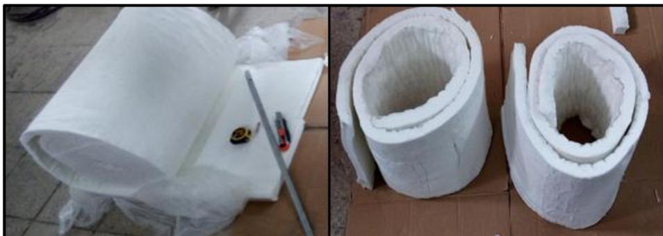
**Figura 3.11: Pedazos de manta refractaria para recubrir al horno**
