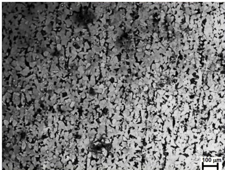
Figura 3.4 Microestructura del material de la brida, Nital 100X
