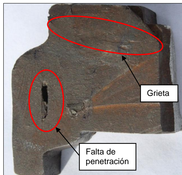
Figura 3.2 Sección transversal de junta tubería – brida
